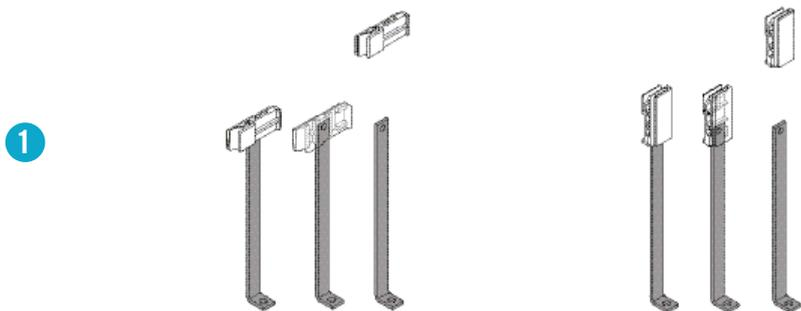
Der Stützbügel-Clip kann sowohl quer als hochkant eingesetzt werden. Dies hält die Anzahl der Teile gering.
